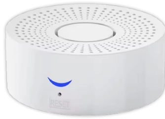
Het basisstation, met het RESET-gaatje onder het blauwe lampje
